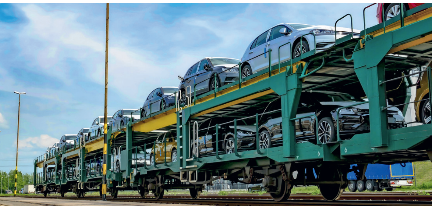
Carrello per trasporto auto aperto con due livelli di carico e parapetto alto 60 cm
