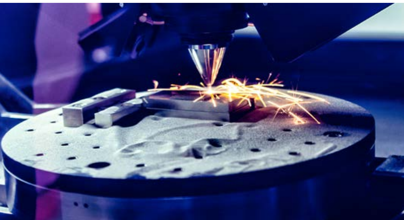
Drukarka 3D wytwarza komponent z proszku metalowego
