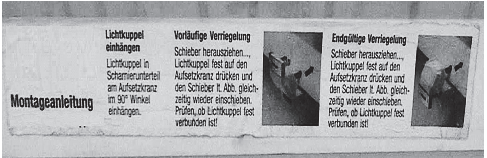
Abb. 18: Unvollständige Montageanleitung (Lichtkuppel)
